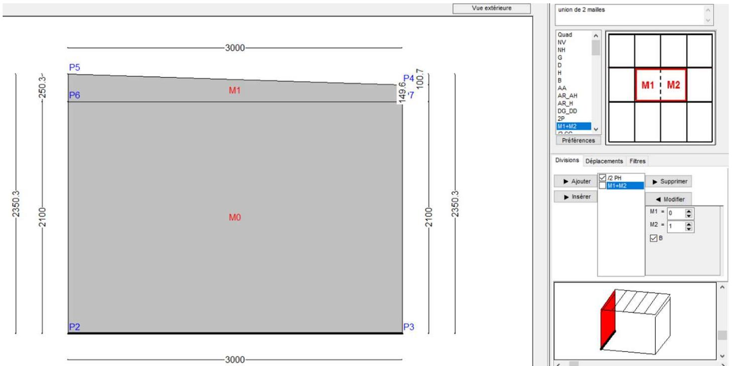
A ce moment, on a fait une union des 2 mailles vers 1 maille trapèze, mais la barre « traverse poteaux » reste active. On sélectionne la maille (unie) et on ouvre la module châssis : Allure 61 + traverse horizontale (hauteur = hauteur dessous chéneau). Dans la partie haute, on peut mettre un panneau qui empêche la vue vers l'extérieur.
