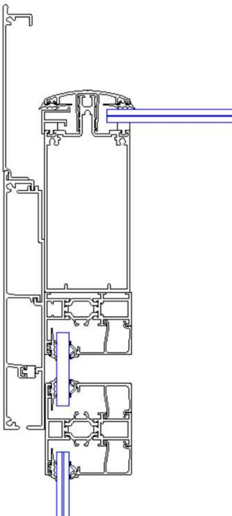
**Châssis partiel dans la maille** : il y a la possibilité de mettre un châssis partiel dans la maille
